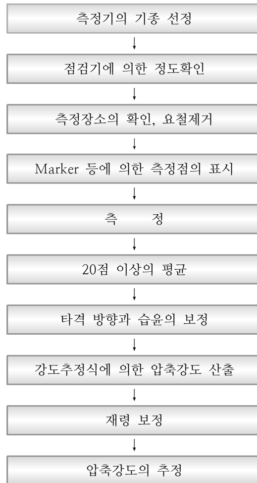
〈그림 3.2.2〉 반발경도법에 의한 압축강도 추정도
